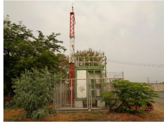
รูปที่ 2 การติดตั้งสถานีตรวจวัดคุณภาพอากาศ แบบอัตโนมัติ (AQMS)
